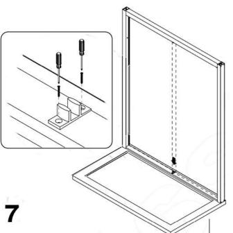
colocar la pinza baja en la guía inferior, en el cruce entre hojas, con los tornillos autorroscantes
